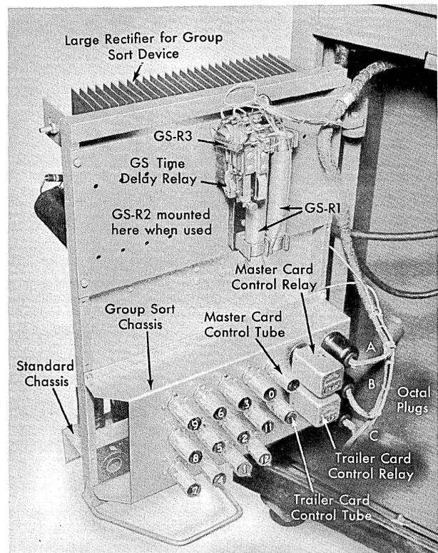
Figure 53. Type 82 Group Sort Relay Gate, 115 volt AC
