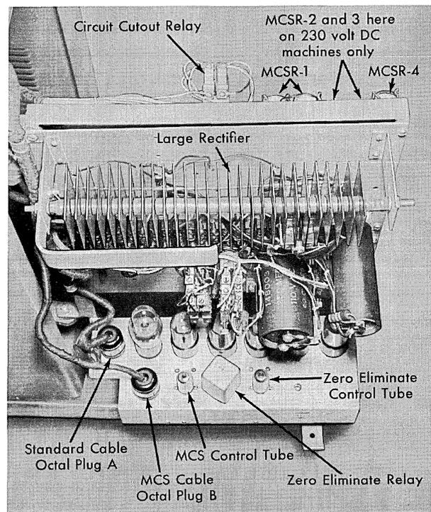
Figure 48. Type 82 MCS Relay Gate, 115 volt AC
